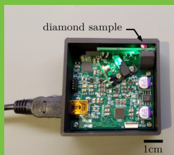
Funktionsmuster eines NV-Zentren basierten Quantensensors inkl. Messergebnissen
